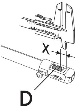
10. Отрегулируйте приток воздуха, сдвинув трубку Вентури "D" до получения расстояния "X", указанного в соответствующих таблицах (см. "Таблицу характеристик конфорок и форсунок", пункт "Первичный воздух (мм)", и закрепите ее винтом "А".
