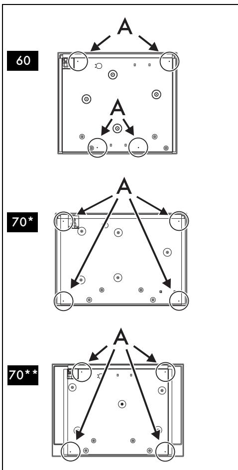
Вкрутите крепежные скобы в соответствующие отверстия, чтобы правильно закрепить варочную панель на встроенной конструкции.
