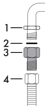
Аккуратно привинтите фитинг 3 к газовому патрубку 1 (резьба  $\frac{1}{2}$  дюйма ISO 228-1) прибора, проложив прокладку 2 из комплекта поставки. Нанесите изоляционный материал на резьбу патрубка 3, а затем заверните гибкий стальной шланг 4 на патрубке 3.
