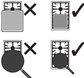
Во время приготовления пищи, чтобы избежать ожогов, повреждение варочной панели или столешницы, все емкости или сковороды-грили должны быть расположены в пределах períметра варочной панели.
