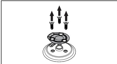
5. Снимите прокладки, имеющиеся на термопарах и свечах каждой конфорки.
